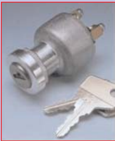
47.00.03 INTERRUPTOR A LLAVE CONTACTO Y ARRANQUE - 0 - 1 - 2 - CONEXIÓN TORNILLO - 12V 8,3A
