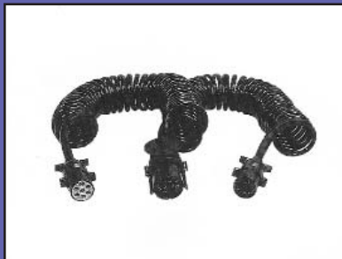
035557 9 CONTACTOS ADAPTADOR ESPIRAL CON CLAVIJA 15 POLOS A CLAVIJAS "N" Y "S" LARGO 4,5 MTS CABLES 2X1+10X1,5+3X2,5
